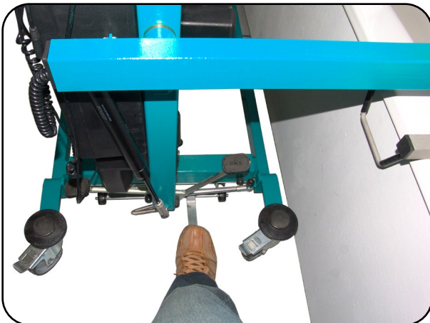
Abb. 9.3.06 – Betätigen des Vorspannpedals
