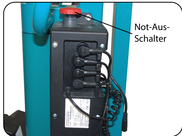
Abb. 8.5.01 – Steuereinheit mit Not-Aus-Schalter
