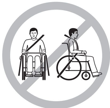
Falsches Anlegen des Gurtes
